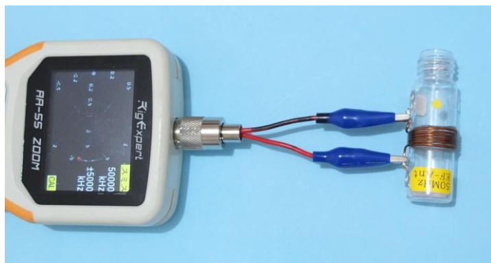
写真 2.1 インダクタンス測定状況
